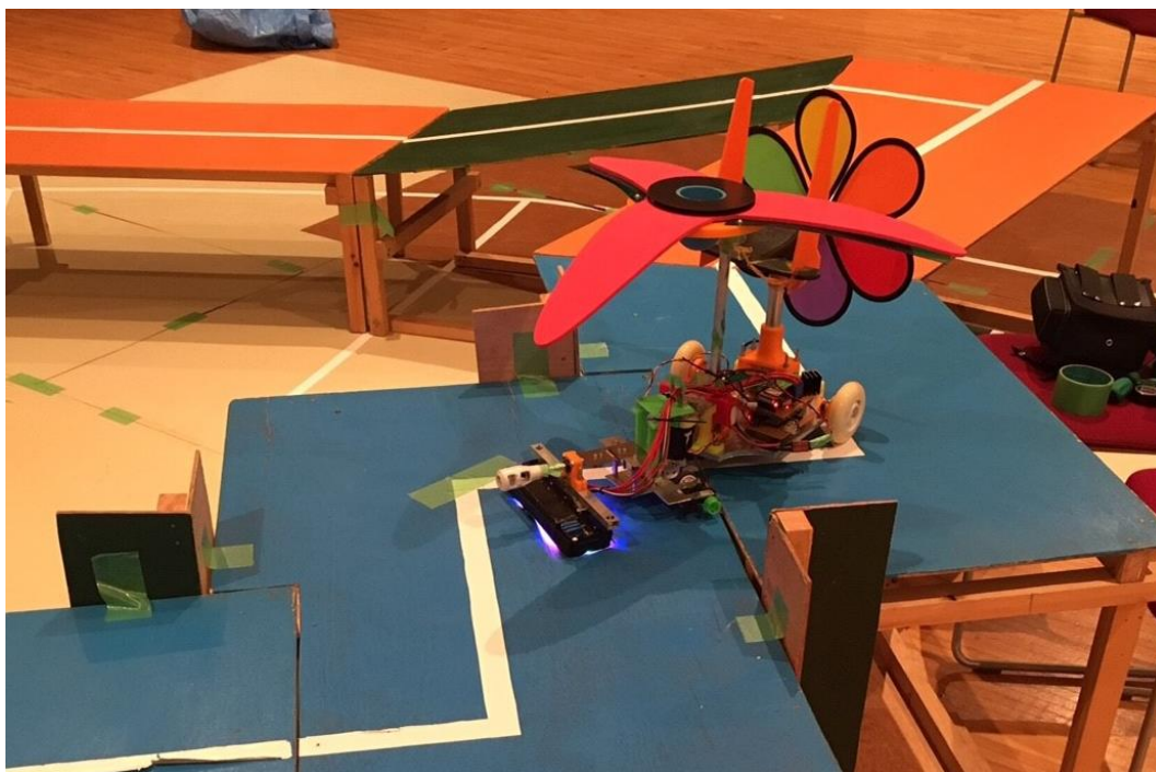
写真：リバーと呼ばれる、ジグザグのコースを進むエコロボット (この区間でも、ラインセンサーの読み飛ばしを行っておりました。)
